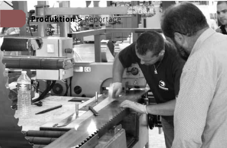
Jahrelange Erfahrung: Das korrekte Richten der Bandsägeblätter wird in Sägerkreisen als regelrechte Handwerkskunst bezeichnet
