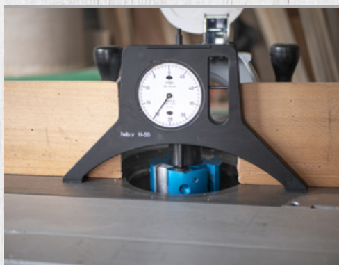
Appareil de mesure de précision HEBOR H-50 Votre meilleur auxiliaire pour le réglage de toupies et de fraiseuses.
